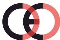
Falsk CE-mærke (for tæt på hinanden)
